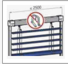
Construction de stores autoporteuse
